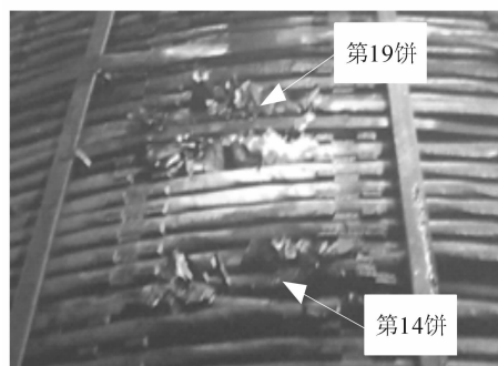
图6 变压器故障位置和痕迹
